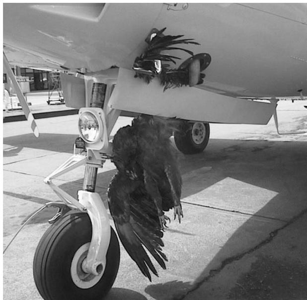
写真 飛行機の脚が出ている状態での鳥との衝突
