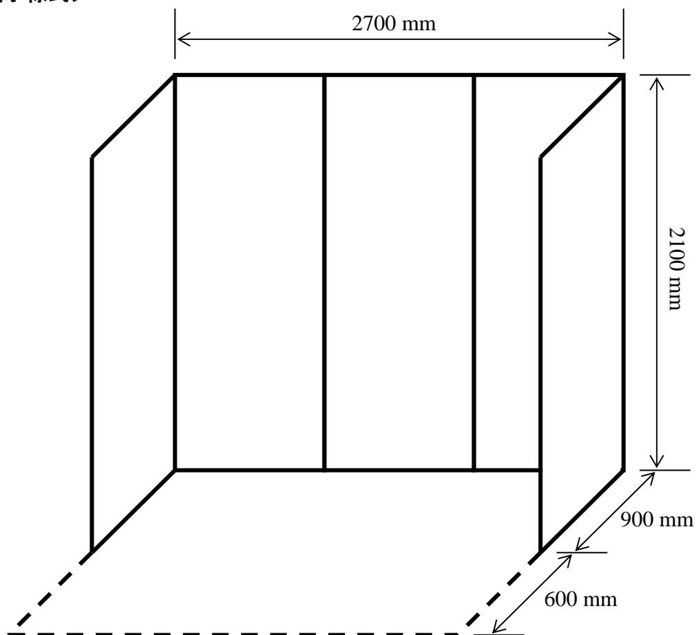
パネルのサイズ: 幅 900mm、高さ 2100mm
